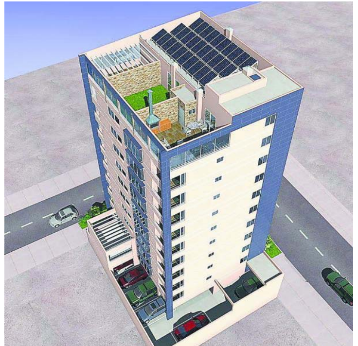
En la terraza del edificio Las Parinas de Constructora Senco se construye una central fotovoltaica con 30 paneles solares.
