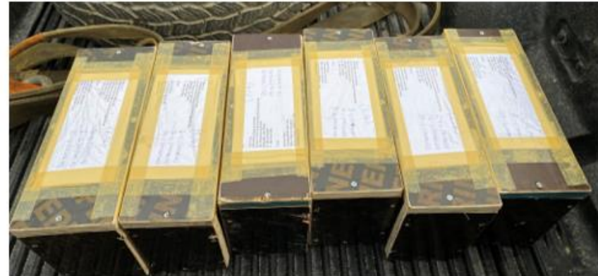
Extracción de testigos, aserrado y embalaje. Ruta Y-65 tramos 2 y 3. Fuente: Elaboración propia.
