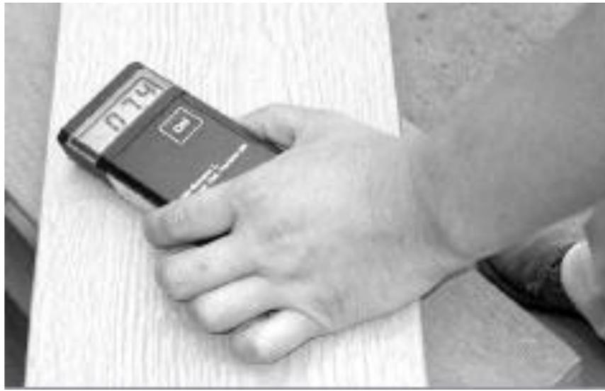
Se recomienda utilizar un higrómetro de superficie para conocer la humedad de la zona de trabajo y poder comparar con la humedad de los tableros.
