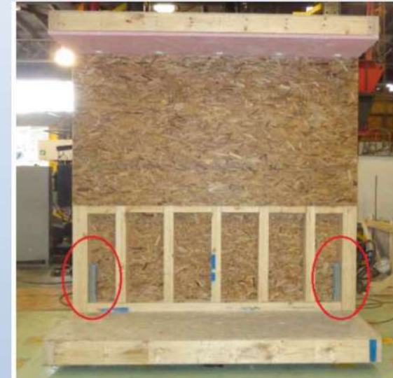
Figura No. 7 – Dispositivo Hold-Down HDQ8 ubicado en muro de ensayo.
