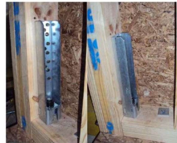
Figura No. 7 – Dispositivo Hold-Down HDQ8 ubicado en muro de ensayo.
